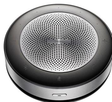
Con un micrófono omnidireccional de 360°, el BM21 es la solución ideal para todas sus necesidades de conferencias. Ligero (395 g) e inalámbrico significa que se puede mover entre ubicaciones con un mínimo esfuerzo y su impresionante duración de la batería de 8 horas con una sola carga significa que nunca se quedará corto. Incluye una distancia de recogida de 5 metros combinada con reducción de ruido.
