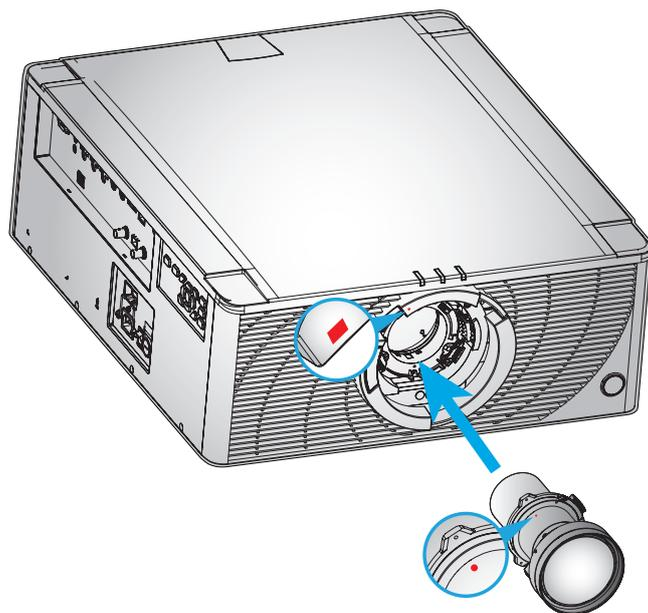
4. Drehen Sie das Objektiv zum Fixieren im Uhrzeigersinn.
