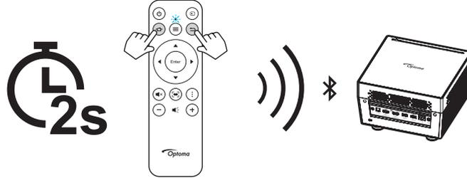
페어링 과정에 약 20초가 걸립니다. 페어링이 성공하면 블루투스 리모컨의 상태 LED가 청색색으로 켜집니다. 페어링이 실패하면 블루투스 리모컨의 상태 LED가 적색으로 켜집니다.
