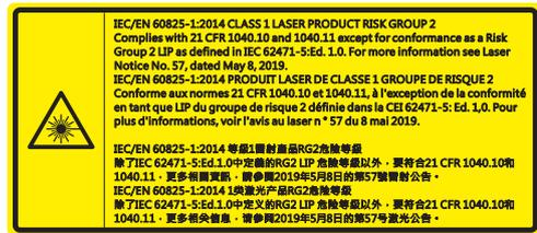
本产品被归类为IEC 60825-1:2014的第1类激光产品-风险群2，并且符合如风险群2之21 CFR 1040.10和1040.11，如IEC 62471-5:Ed.1.0中定义的LIP（激光照明投影机）。有关更多信息，请参阅2019年5月8日的57号激光通知。
