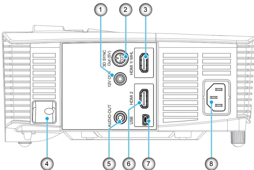
1. Разъем пускового реле (12 В, 250 мА, гнездо «мини-джек» 3,5 мм)
