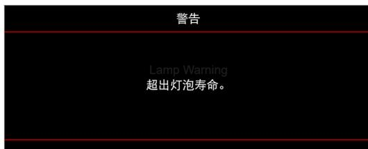
当看到此信息时，请与当地经销商或服务中心联系，尽快更换灯泡。在更换灯泡之前，请务必关闭投影机并拔掉电源线，确保投影机至少冷却30分钟，且灯泡完全冷却。
