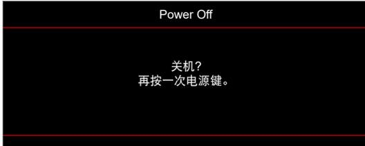
3. 再次按“⏻” / “Ⓜ”按钮以进行确认，否则该消息将在 15 秒后消失。第二次按“⏻” / “Ⓜ”按钮时，投影机将关机。
